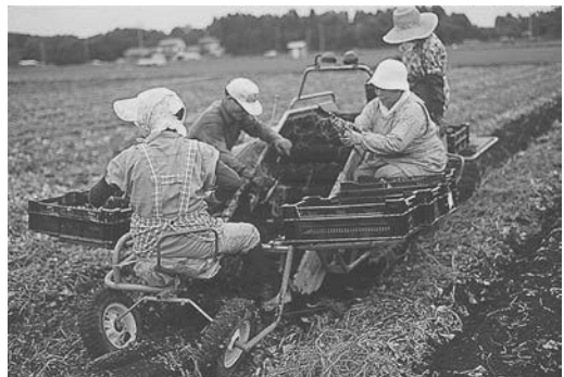
写真4 乗用掘取機によるサツマイモの収穫 部田野では近年2戸の農家が乗用掘取機を導入した。この自動掘取機を使用すると、作業者は掘取りからコンテナ詰めまで、座ったままで作業できる(ひたちなか市部田野, 1998年10月7日, 仁平撮影)。
